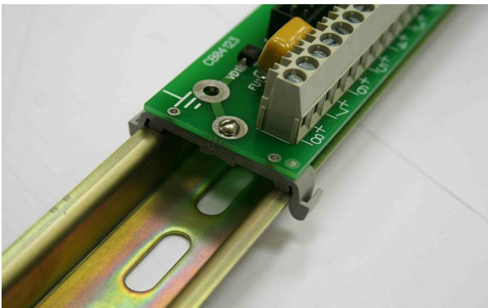
Фото 2. Установка клемника на DIN рейку
